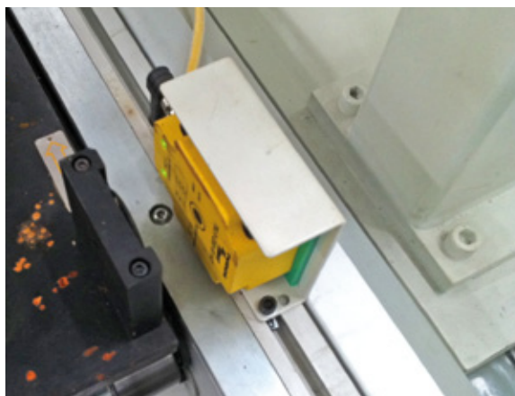
Der RFID-Schreiblesekopf liest den Tag am Werkstückträger im Vorbeifahren aus
