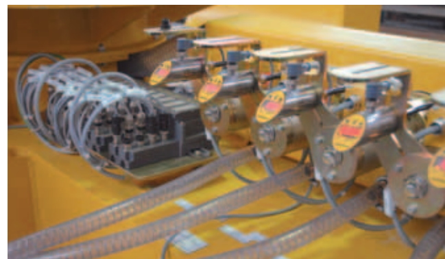
53 Drucksensoren und zwei BL67-I/O-Feldbusstationen verarbeiten die Signale jedes einzelnen Vakuumsaugers
