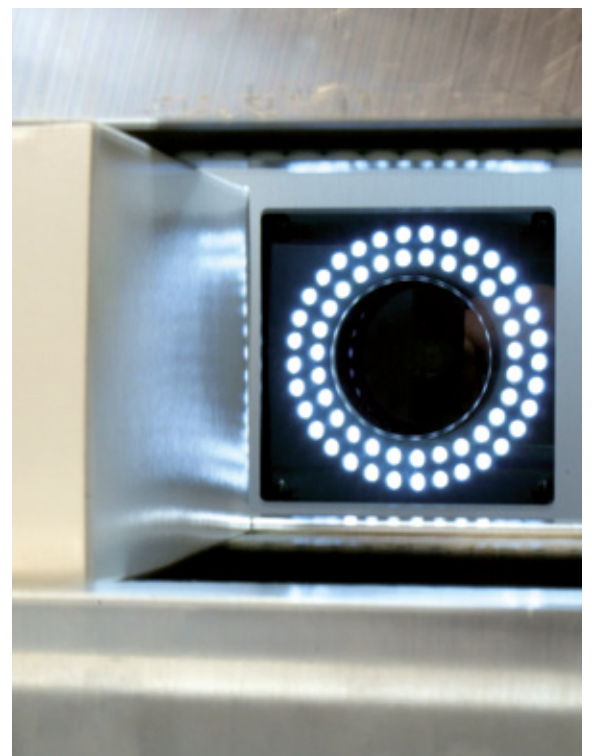
Qualitätskontrolle: Die Kamera überprüft die Druckqualität
