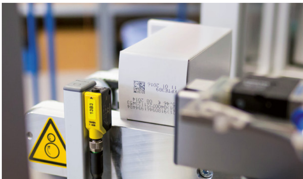
Diese Lichtschranke am Auslauf der PALC unit dient der Gegenwurfkontrolle
