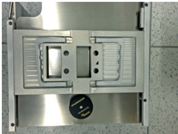
Der RFID-Tag befindet sich oben auf dem Wafer-Träger
