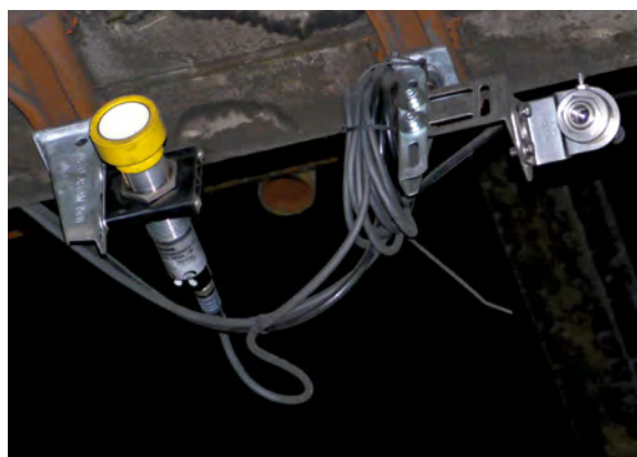
Der Ultraschallsensor löst die Temperaturmessung des Infrarotsensors (links) aus
