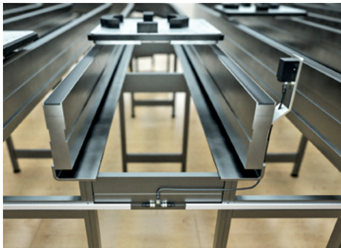
Jede Förderlinie ist am Ende mit einem busfähigen Scheib-Lese-Kopf ausgerüstet, einfach in Linientopologie mit T-Verteilern installiert
