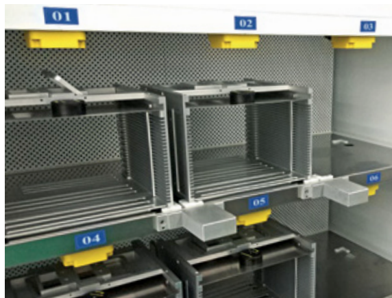
Die RFID-HF-Schreib-Lese-Köpfe an der Oberseite der Materialregale lesen die Tags der Wafer-Träger beim Ein- und Auslagern aus
