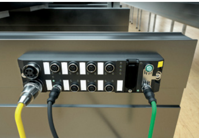
Pro RFID-Kanal lassen sich bis zu 32 busfähige Schreib-Lese-Köpfe anbinden, bei vier Kanälen also 128 Stück pro Interface
