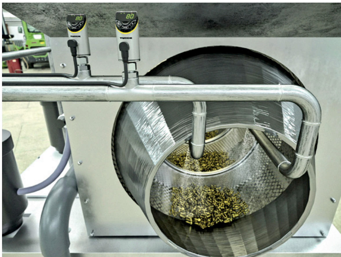
Beispiel Trommelwaschanlage: Die robusten FS+ Strömungssensoren überwachen Strömung und Temperatur flüssiger Medien
