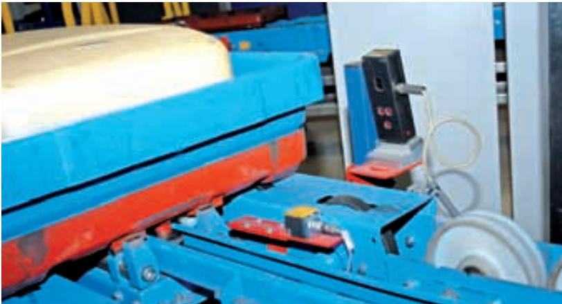
Die Lesestation enthält einen Lichttaster sowie drei Reflexionslichtschranken
