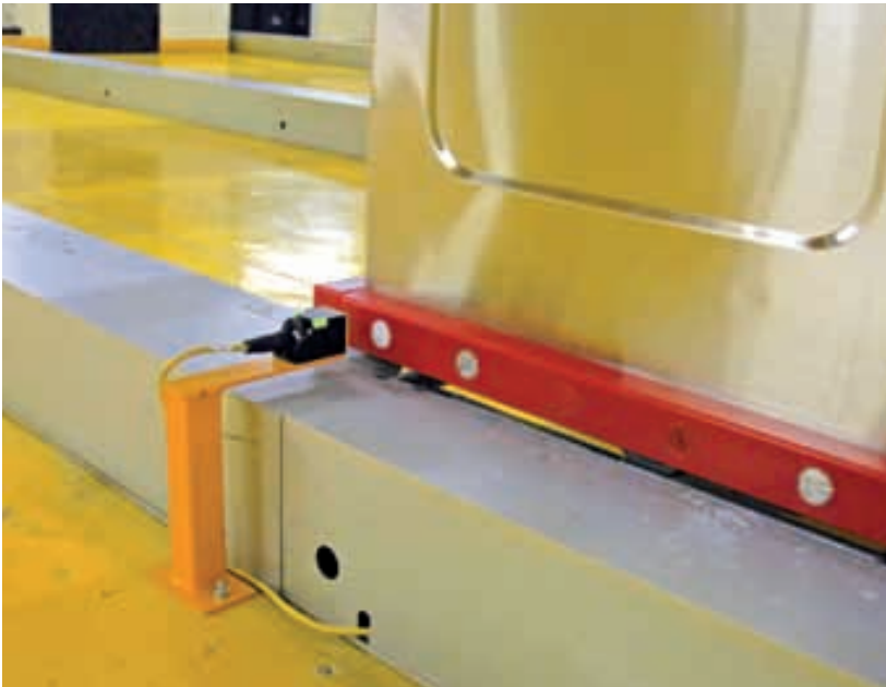
Der Reader liest den in der Stoßleiste eingeschraubten RFID-Tag aus
