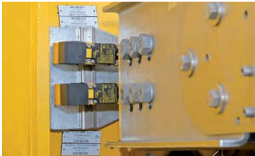
Um zwei induktive Sensoren nebeneinander montieren zu können, hat Turck eine Variante mit versetzter Oszillatorfrequenz entwickelt
