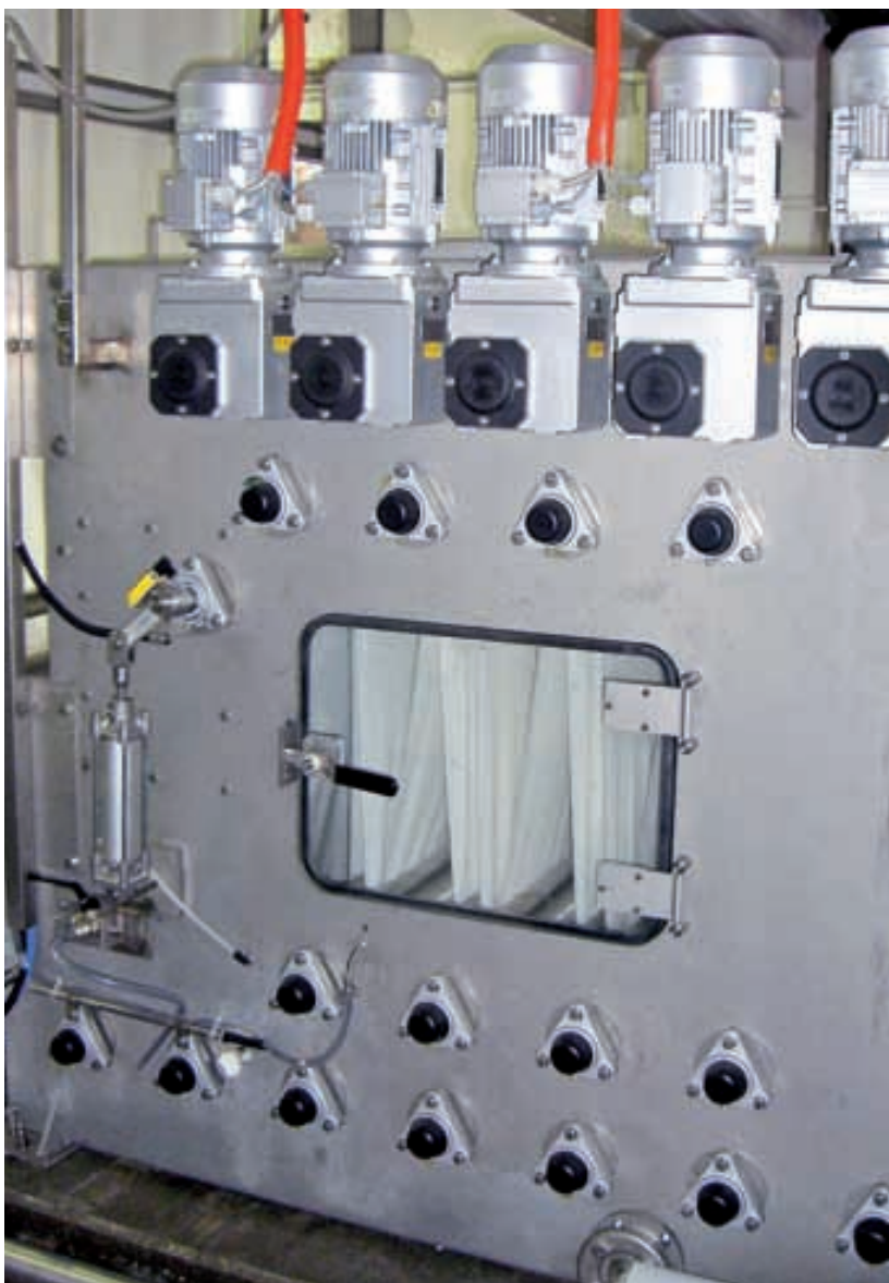
In dieser Continue Wasch- und Bleichmaschine von Erbatech überwacht der Neigungssensor eine Regelschwinge, die die Warenschwingung abtastet
