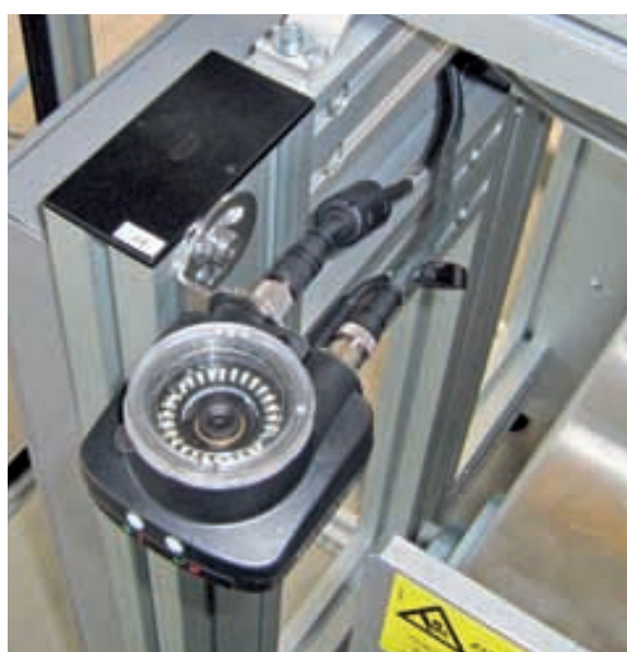
Der DataMatrix/Barcode-Reader aus der Banner iVu-Familie liest den Code vom Figurenrücken
