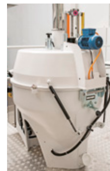
Der Schäl器 MHA im Milling Solutions Technology Center bei der Bühler AG: Unter der Haube hebt und senkt sich während des Schälens ein Prallring
